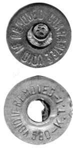
Centro derretido indica sobrecalentado
